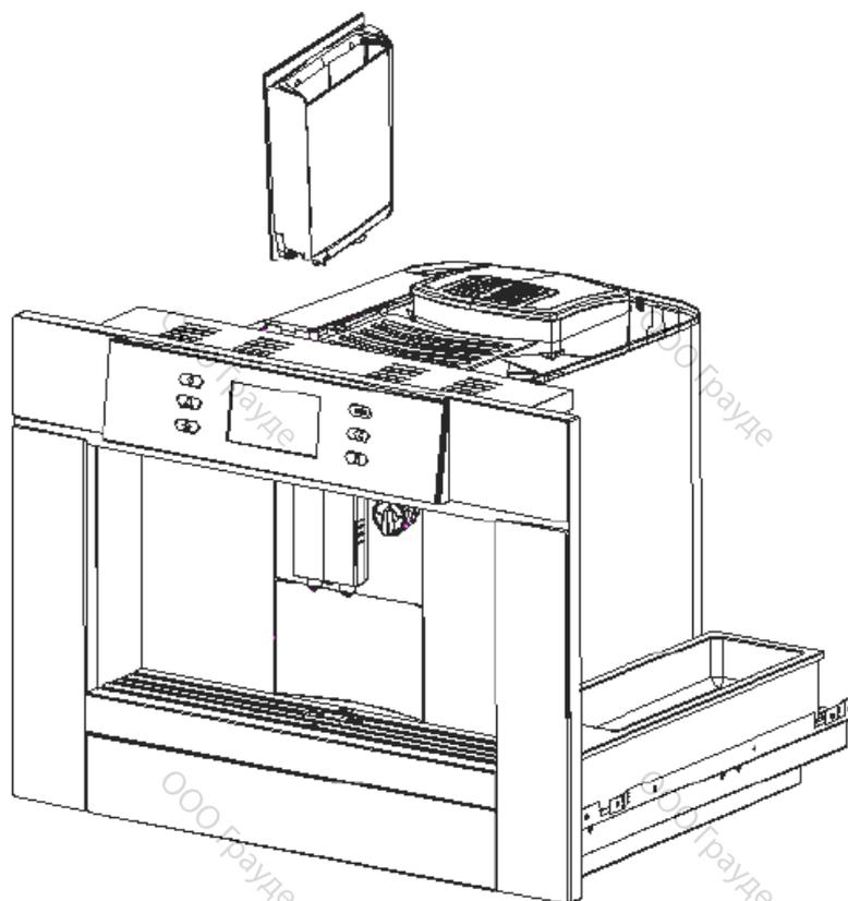
Шаг 7: извлеките емкость и добавьте свежей чистой воды, затем установите емкость на место и задвиньте прибор в нишу.
